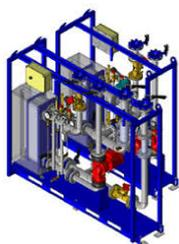
Les **sous-stations** ont pour rôle de permettre le **transfert de la chaleur**, par le biais d'un échange entre le **réseau de distribution primaire** et le **réseau de distribution secondaire**, lequel dessert un bâtiment ou un petit groupe de bâtiments. Une sous-station abrite **un poste de livraison**, où l'eau chaude / la vapeur distribue sa chaleur aux installations du bâtiment.
